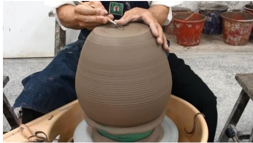
圖 4 修坯壁與修底足
